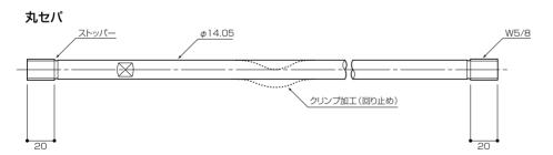
規格品以外のサイズも製作いたします。 全長(壁厚)、ねじ長、材質、クリンプ加工の有無(丸セパ)をご指定ください。
