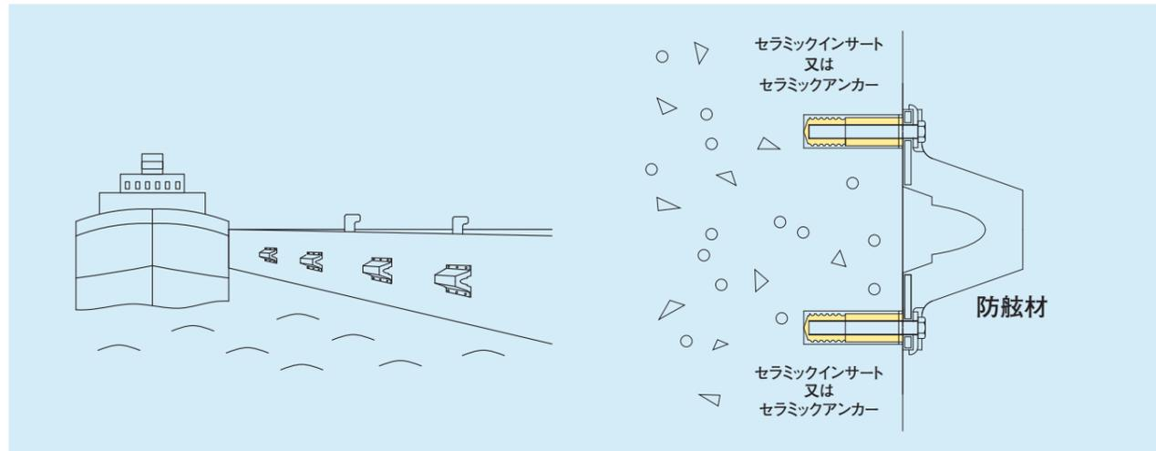
船舶が安全に接岸するために、岸壁には防舷材が設置されています。これら防舷材の取り付け用に、海水にも腐食しないセラミックインサート/セラミックアンカーは最適です。
