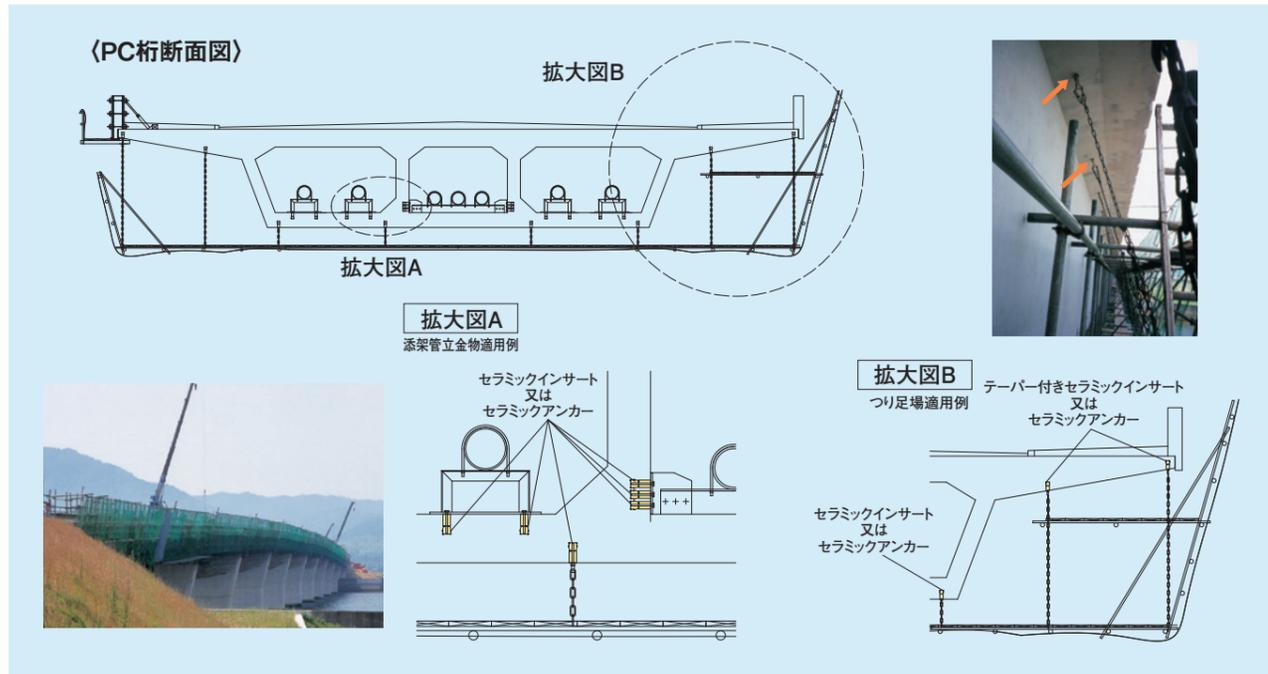
橋りょう工事におけるつり足場・支保工・張り出し足場や水道管・ガス管などの添架物などの固定用に、信頼性の高いセラミックインサート／セラミックアンカーが使用されています。
