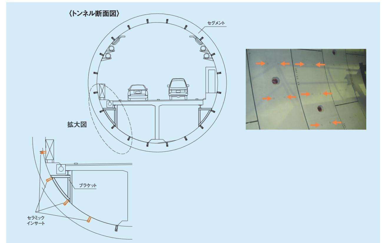
シールドトンネルのセグメントに埋め込まれたインサートは、床版用ブラケットや照明・配管などそのほかの施設の設置に使用されています。そのほか、耐火性能が求められる場所にも最適です。
