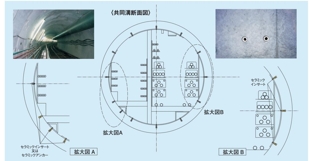
シールドトンネル内の立金物取り付け用として、セラミックインサート／セラミックアンカーが広く使用されています。
